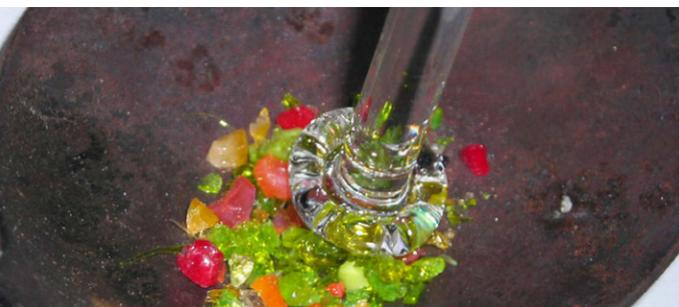
Zuerst machen wir die Spitze des Klarglasstabes heiß und drücken uns eine kleine Maria. Das ist eine kleine Platte unten am Glasstab. Kommt im Durchmesser nicht zu groß, sonst wird der Ohrstecker später zu groß.
