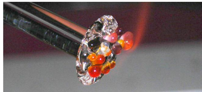
Wir drehen also den Stab senkrecht über der Flamme, mal näher und mal weiter weg. Wichtig ist, dass eine Implosion immer sehr langsam läuft.
